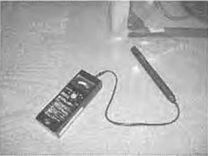
ガス漏れ点検
